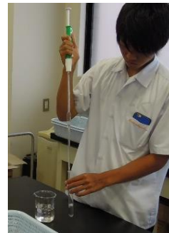
ホールピペットに安全ピペットを付けて使用
